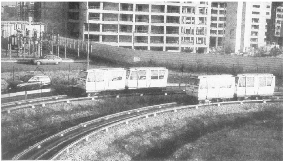
... Mais après avoir franchi un embranchement, les deux doublets suivent chacun leur chemin, irriguant ainsi, sans rupture de charge, les réseaux de transport qu'une ligne traditionnelle ne saurait desservir (photo RATP).
