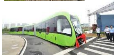
Tram sur pneu sans rails ni chauffeur, 70 km/h, batteries, Chine, « since 2017 »
